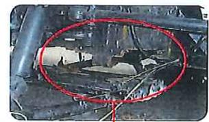
主要骨格部位の腐食による穴あき等は、堅ろうではないとして保安基準不適合
